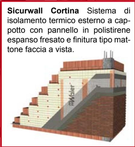
**Sicurwall Cortina** Sistema di isolamento termico esterno a cappotto con pannello in polistirene espanso fresato e finitura tipo mattoncino faccia a vista.
